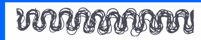
Filo testurizzato (procedimento KDK)
